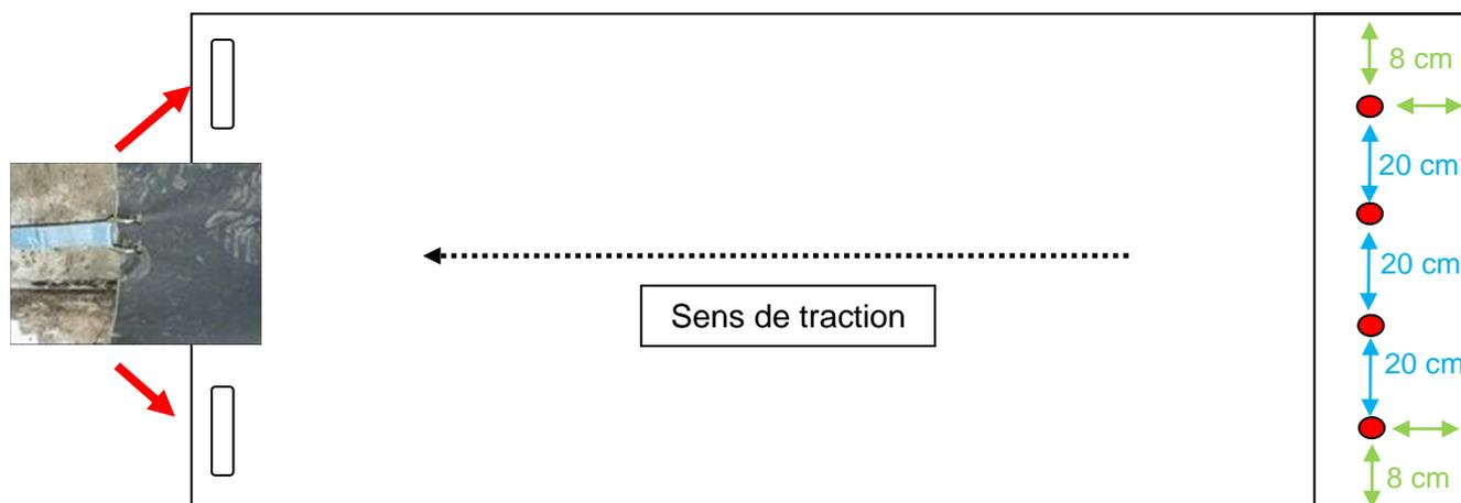
**Astuce :** Utiliser une pince étau, un serre joint ou une sangle à cliquet pour pincer et tendre le caoutchouc.
